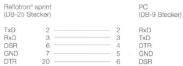
Abbildung 6: Reflotron Kabelkonfiguration
